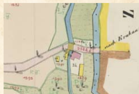
Okolice młyna w Żarkach na mapie z 1848 roku. Warto zwrócić uwagę na równoległy względem Chechła kanał wodny zasilający budowlę.
